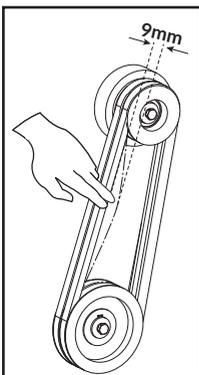
La correa tiene que tener una tensión tal que al presionarla con los dedos puede flexar 9mm. Para ajustar la tensión de la correa hay que desplazar el motor, para ello:
