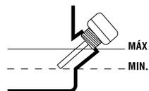
**⚠️ NOTA:** Questa macchina ha un sensore di olio per evitare l'avviamento del motore con il livello dell'olio sotto del minimo raccomandato. Se il livello dell'olio motore è insufficiente non si avvia.
