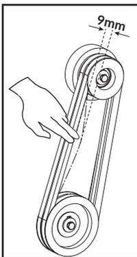
viene premuta con le dita può flettere di 9 mm. Per regolare la tensione della cinghia, il motore deve essere spostato, per fare ciò:
