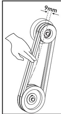
La courroie doit avoir une tension telle que, avec les doigts, elle puisse fléchir de 9 mm. Pour régler la tension de la courroie, le moteur doit être déplacé. Pour ce faire:
