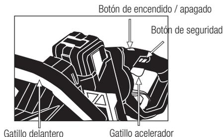
**ADVERTENCIA:** Tenga cuidado con los bordes afilados de las cuchillas. Las cuchillas continúan girando unos instantes después de apagar el motor. Espere a que las cuchillas se hayan detenido completamente antes de volver a poner en marcha la máquina. La cuchilla no se detiene instantáneamente al soltar el interruptor On/Off. La cuchilla se para antes de 0,5 segundos después de haber soltado el interruptor On/Off.
