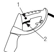
Pressez le bouchon de sécurité (1) et, sans le lâcher, pressez l'interrupteur On/Off (2).
